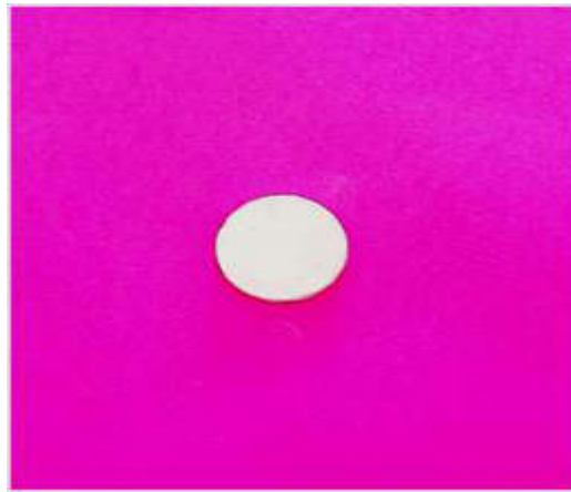
الشكل(5-3):شكل القرص (الهدف) بعد عملية الكبس.
