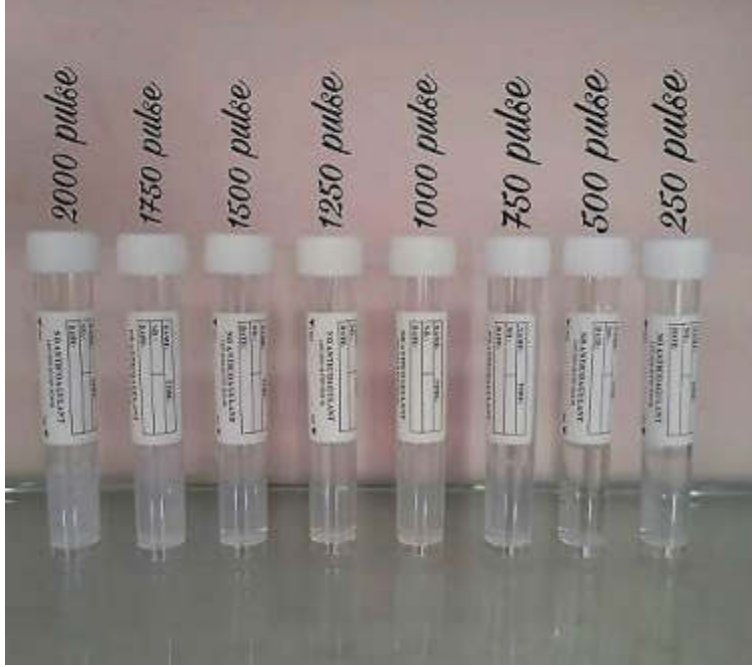
الشكل (4-16): شكل المحاليل لجسيمات أوكسيد الزركونيوم النانوية المحضرة بتقنية الاستئصال بالليزر النبضي في السائل وبعدد نبضات مختلفة.
